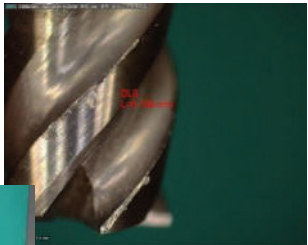
Após 180min de usinagem a fresa concorrente A, o desgaste de flanco na aresta inferior foi 0.106
